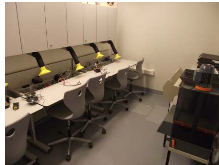
Pienestä varastosta tehtiin elektroniikan työtila, jossa on sähkötyöpöydät, juotoskäryjen poisto integroituna komponenttien säilytysjärjestelmään sekä piirilevyn valmistusyksikkö nopealla suihkusuoytytimellä. Takana valotusyksikkö. Sähkötyöpöydissä ovat tarvittavat juotosasemat, virtalähteet sekä yleismittarit. Huoneeseen mahtuu kuusi oppilasta työskentelemään yhtäaikaan.
