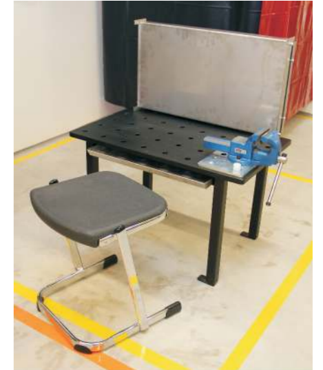
Yhteistyössä tilaajan ja toimittajan kanssa suunniteltu, paremmin käyttäjän tarpeet täyttävä uudenlainen hitsauspöytä. Kuvassa myös osa lisävarusteista.
