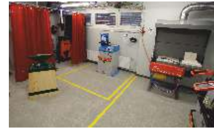
Kuumakäsittelytilassa on ahjon tilalla nykyaikainen kuumatyöpiste sekä pystynauhahiomakone omalla pölynpoistoyksiköllä.
