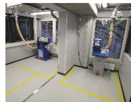
Erillinen pölytyöhuone on myös hyvin varusteltu: kaksi hiontapöytä säädettyväällä imulla, rulla- ja lamellihiomakoneet sekä kuvassa näkyvät pysty- ja vaakanauhahiomakone.
