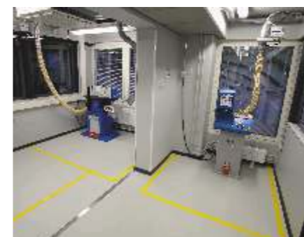
Erillinen pölytyöhuone on myös hyvin varusteltu: kaksi hiontapöytää säädettävällä imulla, rulla- ja lamellihiomakoneet sekä kuvassa näkyvät pysty- ja vaakanauhahiomakone.
